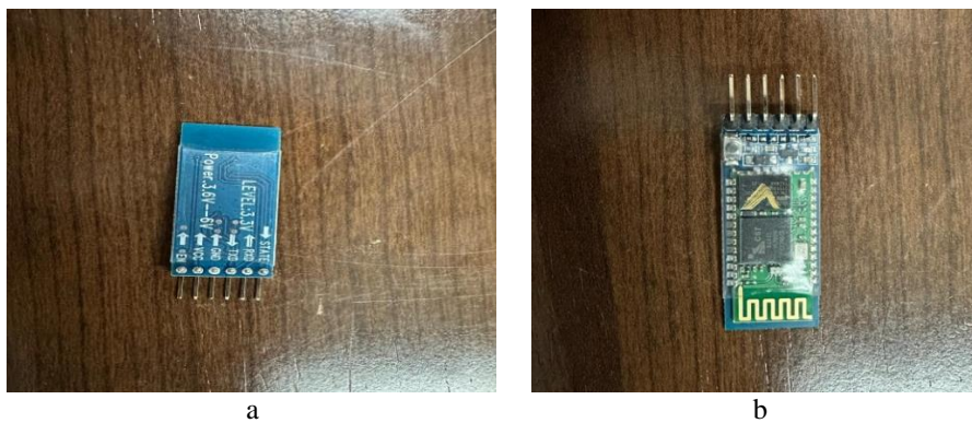
Fig. 4. Bluetooth module: a. front side, b. back side
