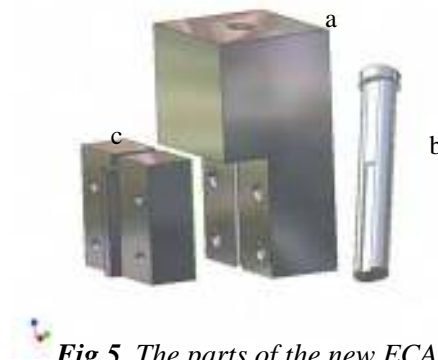
Fig.5. The parts of the new ECAE die a. piston, b. the die body, c. the die knife
