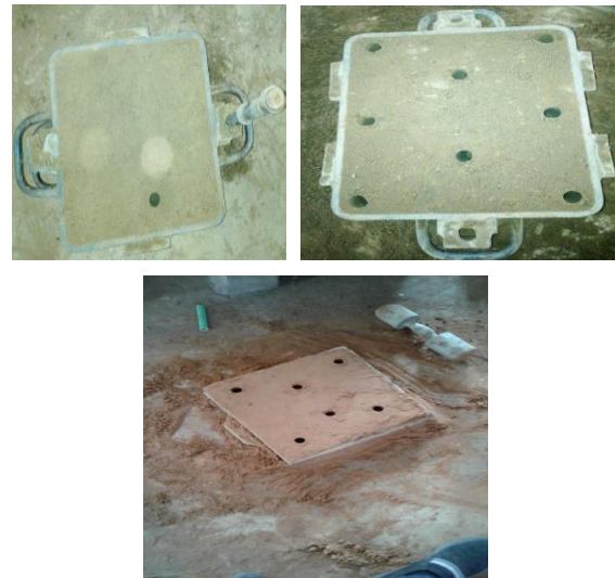
Fig. 11. The moulds ready for pouring
