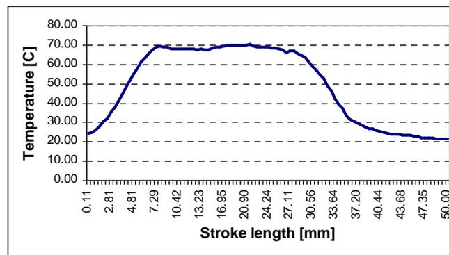
Fig. 5. The rod thermal gradient
