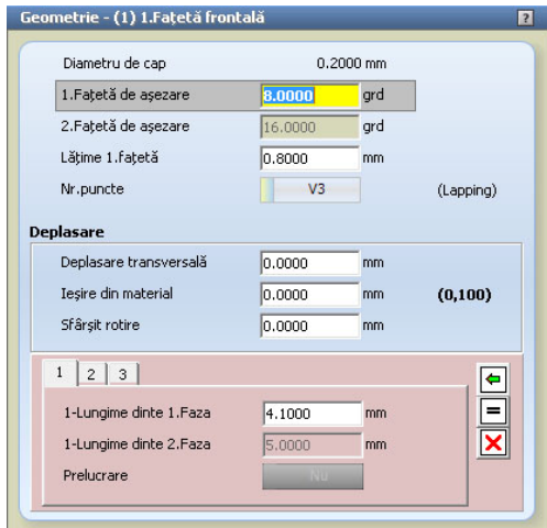
Fig. 21. Parameter values for facets geometry
