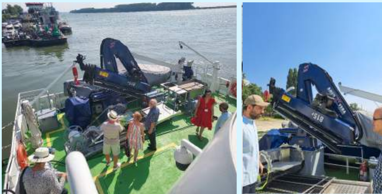
Pe punte, un braț telescopic pentru colectarea probelor
