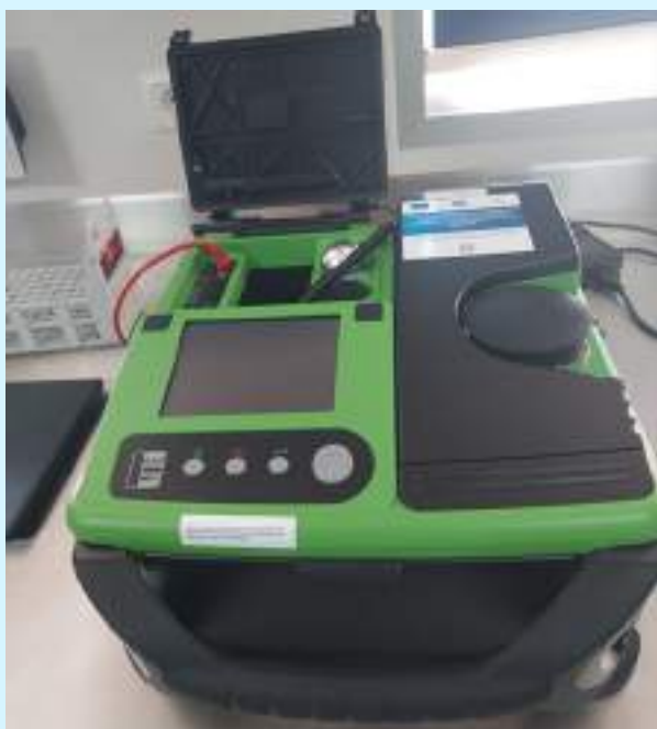
Gaz cromatograf portabil cuplat cu spectrometru de masă
