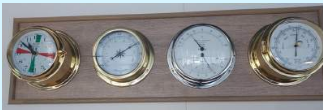
Panou instrumente navale de mare precizie din Zona Hanseatică, Hamburg: ceas, termometru, higrometru, barometru
